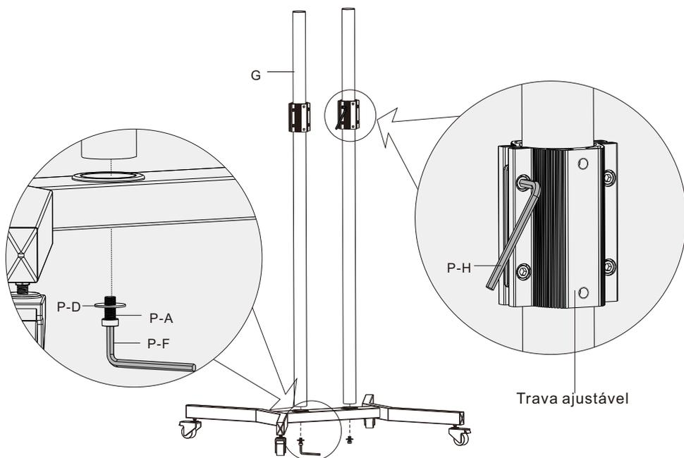
Anexe os dois bastões utilizando parafusos e arruela e aperte os parafusos utilizando uma chave Allen de 8mm, afrouxe os parafusos e ajuste a Trava ajustável na posição desejada utilizando uma chave allen de 5mm.
