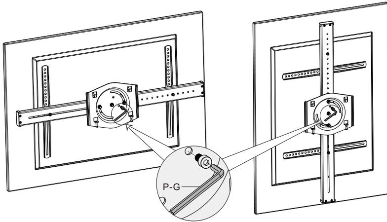
Afrouxe os parafusos da placa de suporte com uma chave allen de 6mm e gire a tela em 90° e então firme com o parafusos em outra posição.
