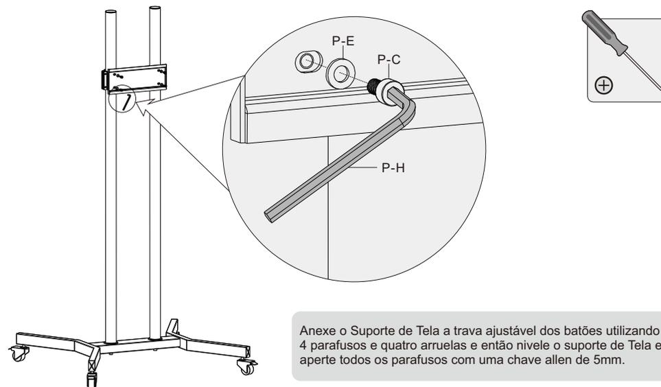
Anexe o Suporte de Tela a trava ajustável dos bastões utilizando 4 parafusos e quatro arruelas e então nivele o suporte de Tela e aperte todos os parafusos com uma chave allen de 5mm.
